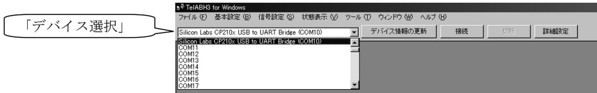
パソコンとサーボドライバをつなぎ、「デバイス情報の更新」をクリックします。(「デバイス情報の更新」をクリックすることで「デバイス選択」に表示されるデバイス名が更新されます。)
